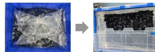
生産工程で使用するビニール袋を再利用可能なプラスチックケースに置き換え(蘇州工場)
