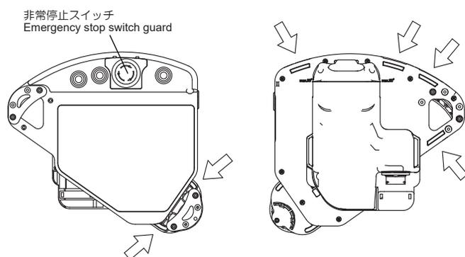
HT4Pの取り付け穴(矢印部)にストラップを(1)～(3)の手順で取り付けてください。
